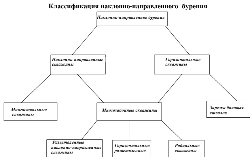
Рис.1 Классификация наклонно-направленного бурения
