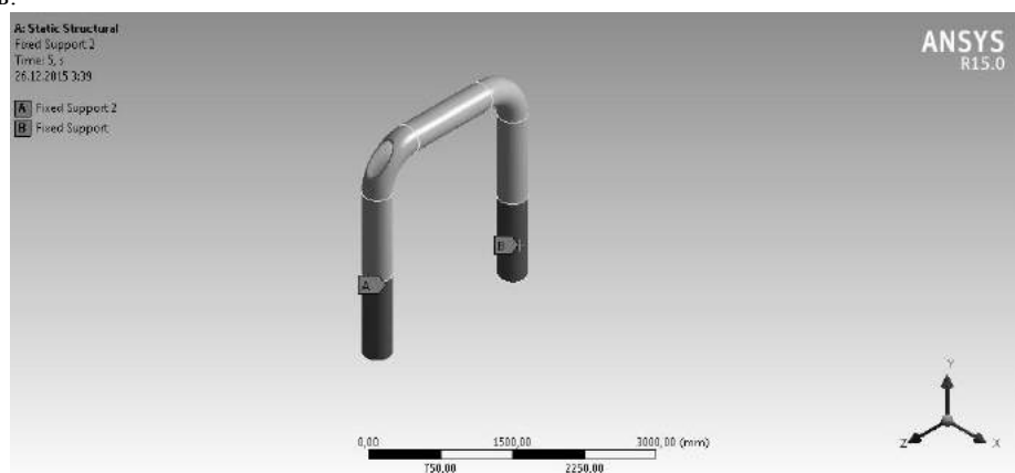
Рис. 3. Жесткое закрепление на концах участка трубопровода
