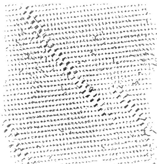
Рис. 1. Кристаллизация леннард-джонсовской системы. Показаны центры симплексов Делоне, форма которых близка к правильной тетраэдрической. Ряды изолированных точек представляют структуру ГЦК. Неупорядоченные кластеры из отрезков показывают локальные дефекты. Ряды коротких отрезков означают слои структуры ГПУ.
