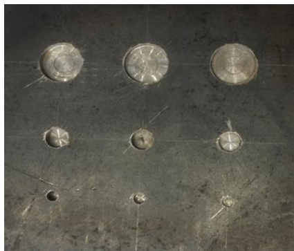
Рис. 1. Образец из стали Ст45 с дефектами задней поверхности, имитирующими скрытую коррозию.
