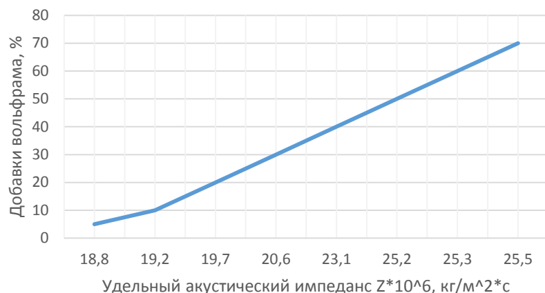
Рис. 2. Зависимость удельного акустического импеданса от процентного содержания вольфрама
