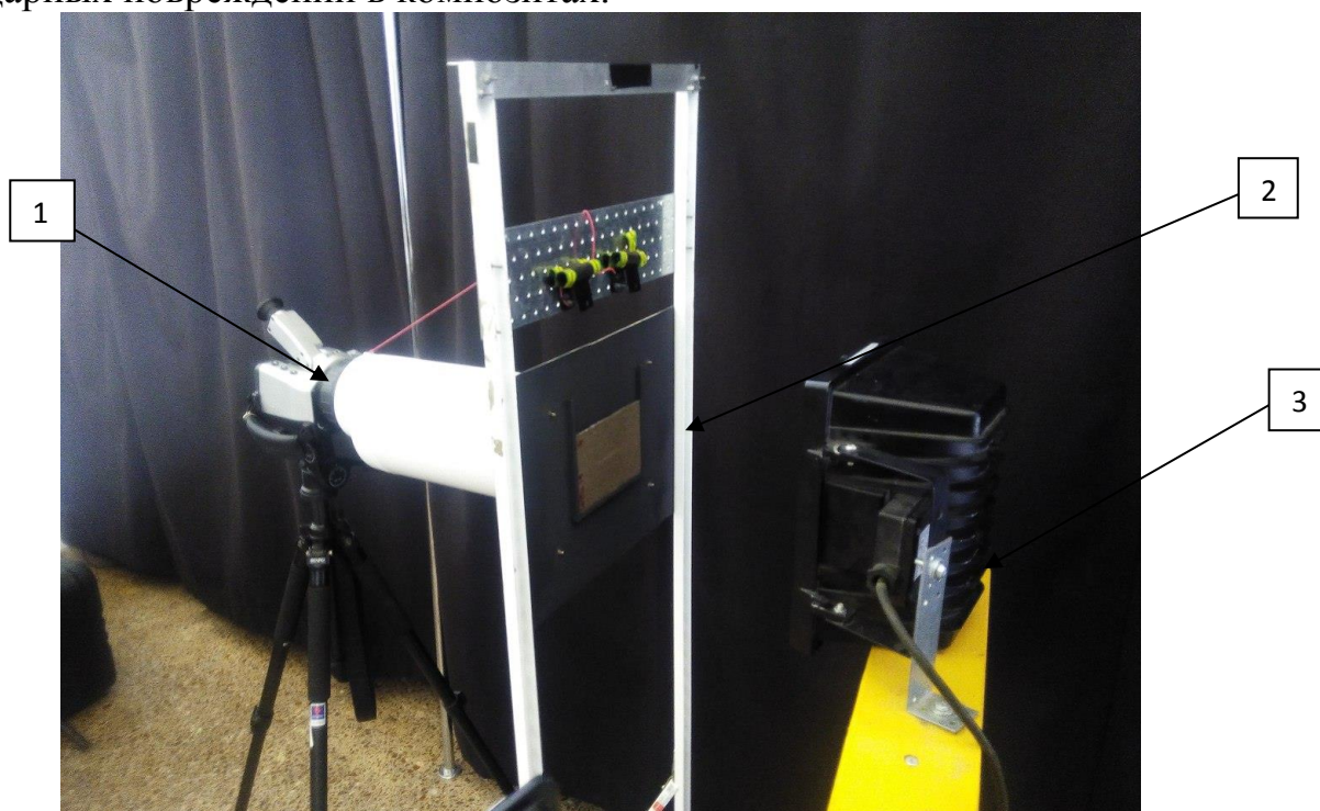
Рисунок 2. Экспериментальная установка для тепловизионного контроля композитов: 1- тепловизор NEC 9100, 2- углепластиковый образец, 3- галогенная лампа на 1 кВт.
