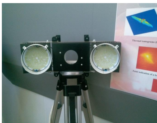
Рис. 2. Лабораторная установка со светодиодными матрицами.
