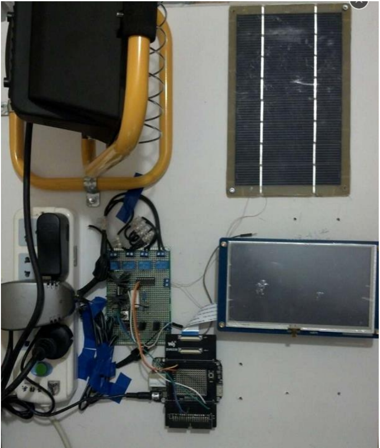
Рис. 2. Система контроля параметров солнечных батарей на основе миникомпьютеров Beaglebone
