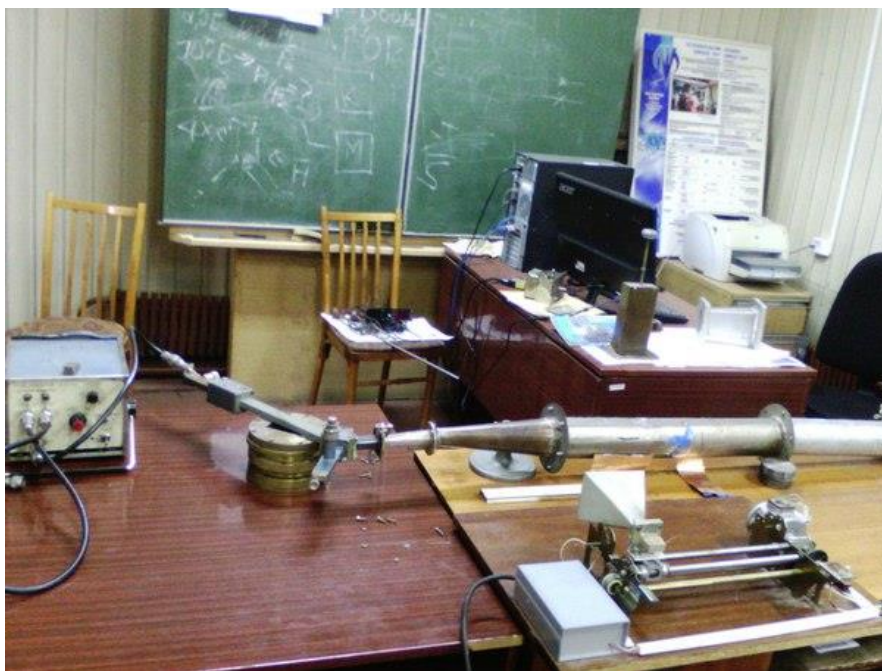
Рисунок 2 - лабораторный макет радиоволнового дефектоскопа.
