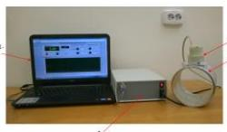
Рисунок 2 – Вихретоковый толщиномер ВТ-15.01
