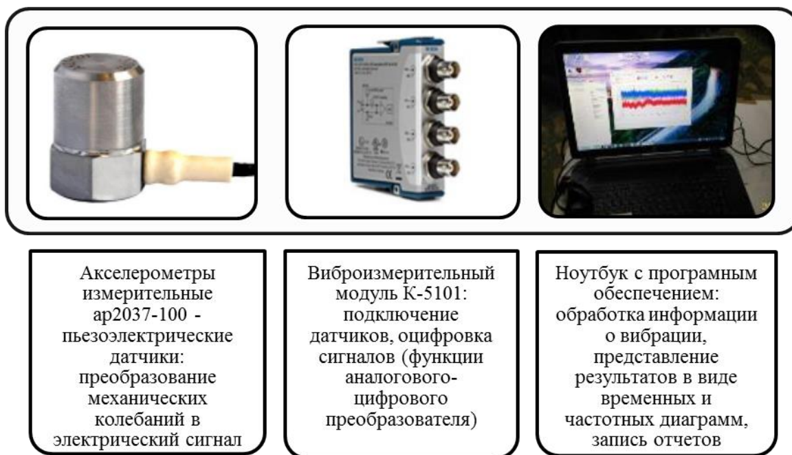
Рис. 1. Модули диагностического комплекса
