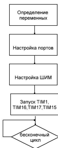
Рисунок 5 Алгоритм управления инверторами
