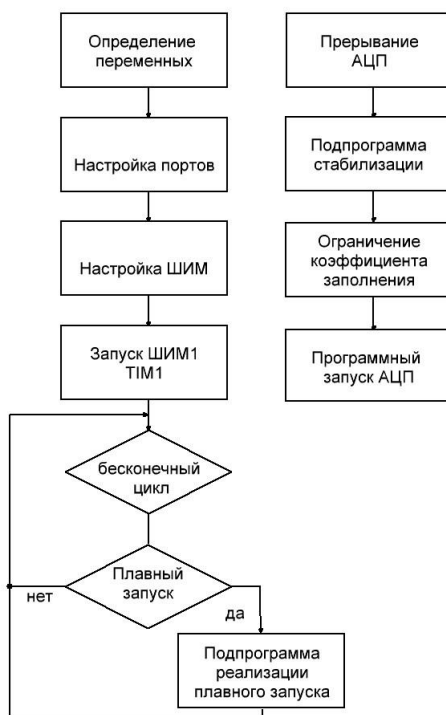
Рисунок 6 Алгоритм управления ПИИ
