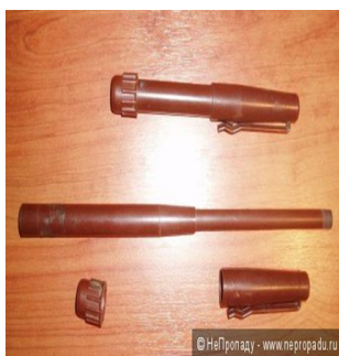
Рисунок 1. Биофильтр индивидуальный портативный БИП-1
