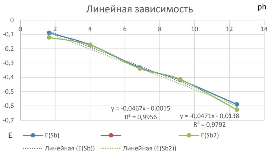
Отсюда были сделаны выводы, что большая шероховатость и большая площадь поверхности электрода отрицательно сказывается на точности данных.
