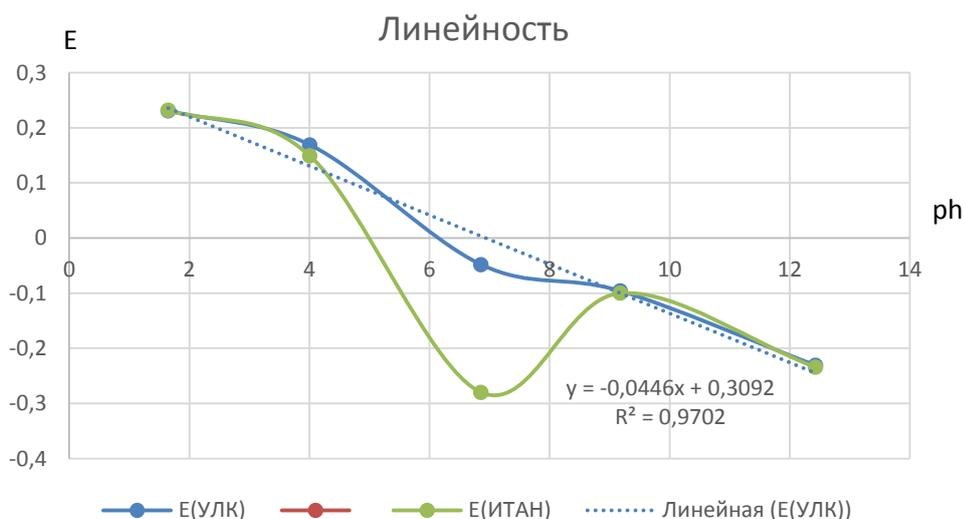
Достаточные отклонения от прямой линии говорят о неточности измерения, и каких-либо проблемах в устройстве. Из возможных проблем выделялись следующие: большая шероховатость поверхности измерительного электрода, слишком большая площадь поверхности измерительного электрода, в процессе измерения участвовал оловянно-свинцовый сплав, в качестве припоя, но как было выяснено позже буферные растворы были приготовлены неправильно, хотя предыдущие проблемы тоже имели место быть.
