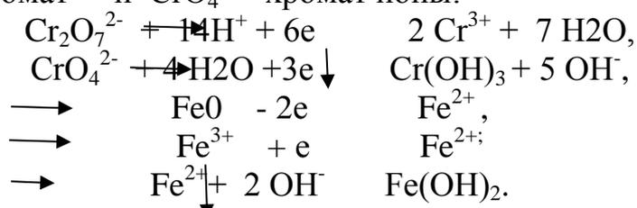
Таким образом, в результате происходящих процессов образуются гидроксиды  $Fe^{2+}$  и  $Fe^{3+}$ ,  $Cr^{3+}$ , а также других тяжелых металлов, ионы которых могут присутствовать в сточных водах, при этом достигается минимальная концентрация  $Cr_2O_7^{2-}$  и  $CrO_4^{2-}$ .
