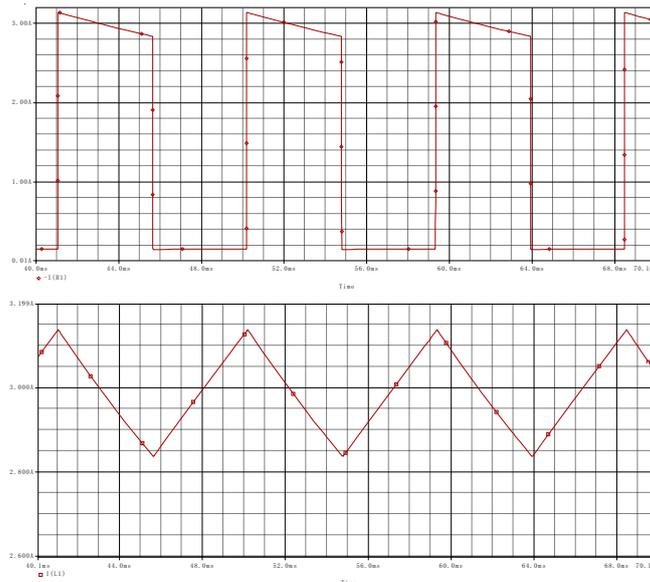
Рис. 4. Диаграммы тока на резисторе  $R1$ , дросселе  $L$ . Параметры элементов:  $L = 150 \text{ мН}$ ;  $R1 = 7 \text{ Ом}$ ;  $R2 = 1 \text{ Ом}$ ;  $R3 = 500 \text{ Ом}$ ;  $R4 = 2 \text{ кОм}$ ;  $R5 = 500 \text{ Ом}$ ;  $R6 = 1 \text{ кОм}$ ;  $V1 = 14 \text{ В}$ ;  $V2 = 15 \text{ В}$ ;  $V3 = 2.9 \text{ В}$
