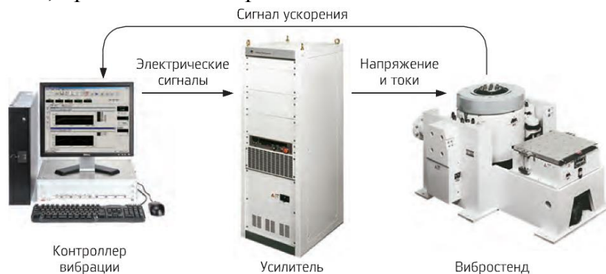
Рис. 1. Схема принципа действия вибростенда
