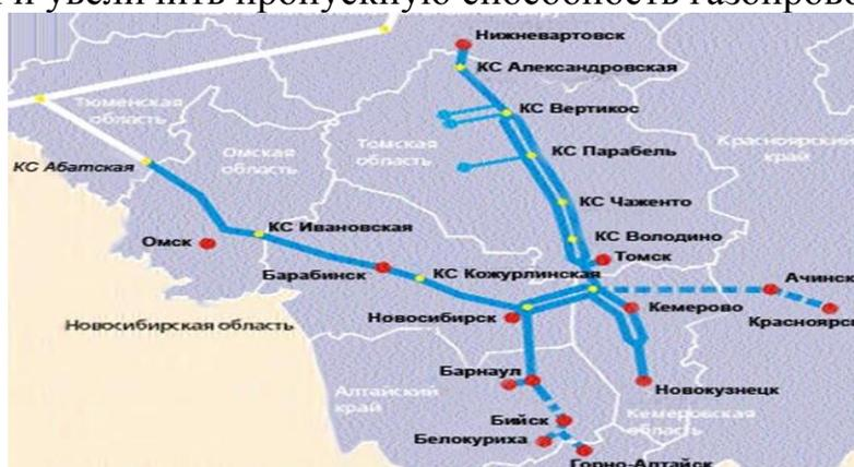
Рисунок 1 – Схема газотранспортной системы на территории Сибири
