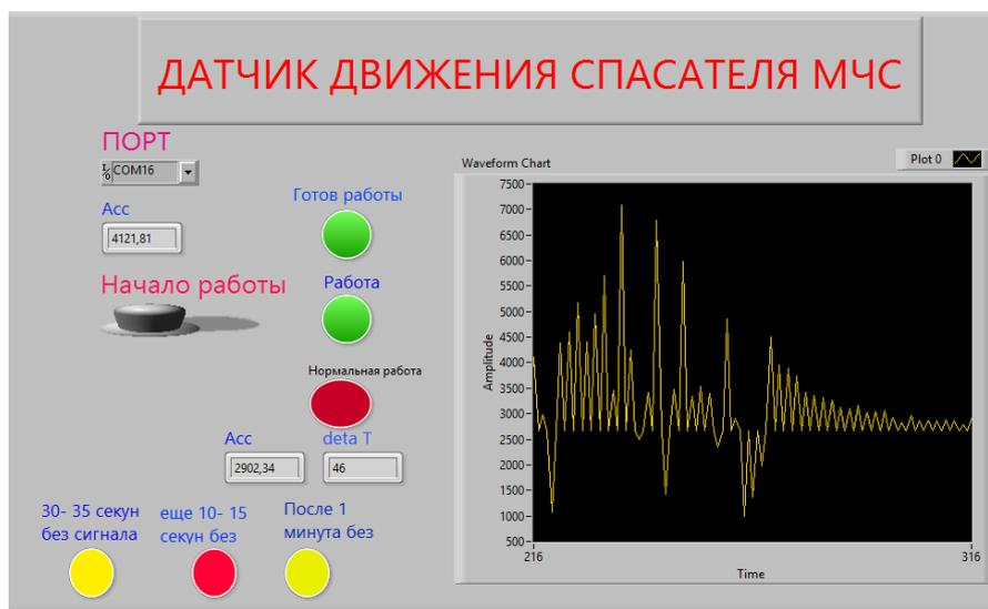
Рис.2. Экран монитора – сигнализатор датчика движения спасателя
