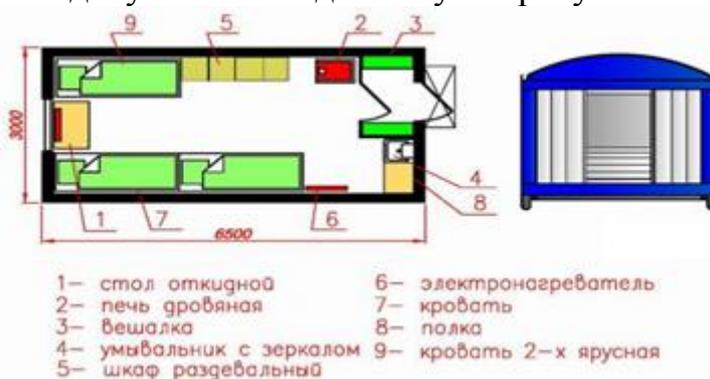
Рисунок 2 – Жилое, блочно-модульное здание
