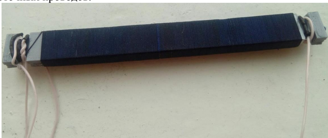
Рисунок 2. Внешний вид макета феррозонда
