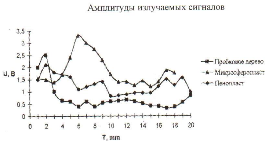
Рис. 2 Зависимость амплитуды излучаемых акустических импульсов от толщины протектора: 1 – микросферопласт, 2 – пенопласт, 3 – пробковое дерево.
