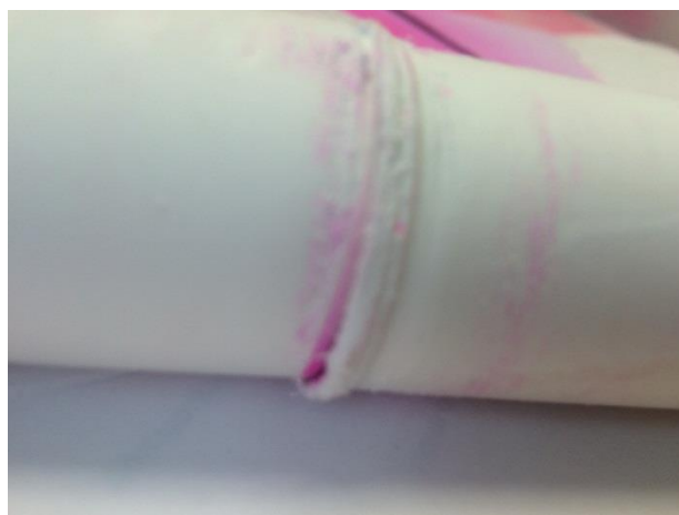
Рисунок 1 – обнаруженные дефекты при проведении капиллярного контроля.
