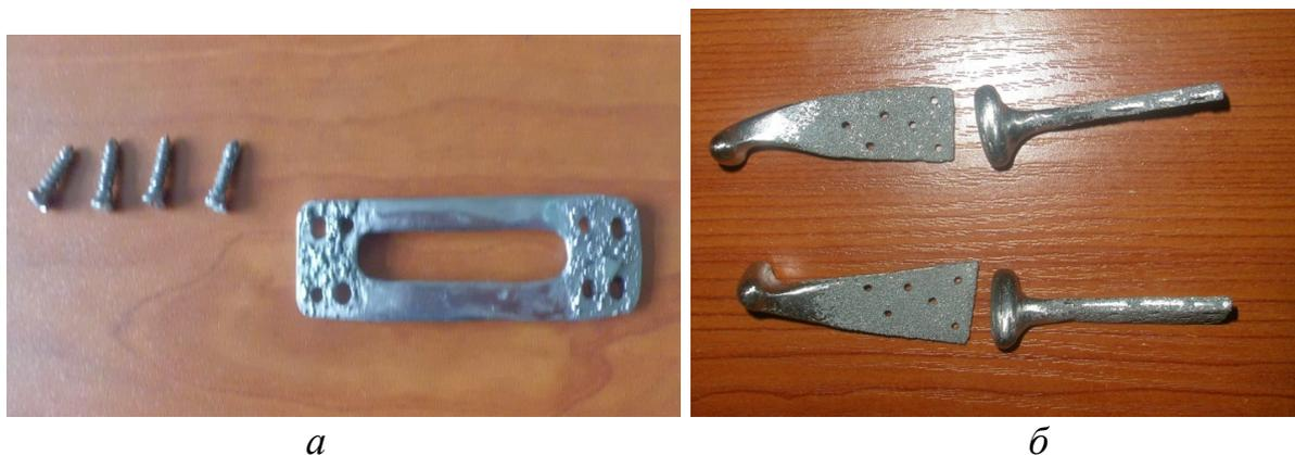
Рис. 1. Эндопротезы из пористо-проницаемого никелида титана:
