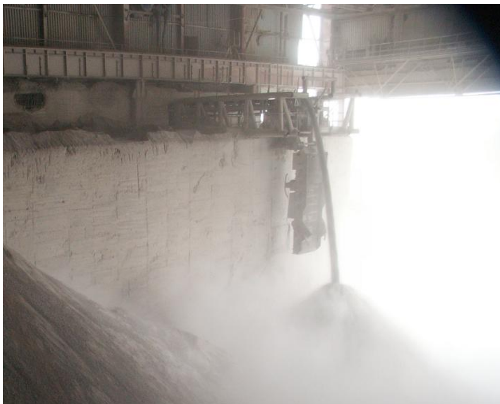
Рисунок 5 - Выделение пыли при ссыпании материала из конвейера в склад
