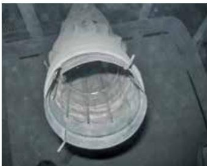
Рисунок 11 – Образец рукава с новыми каркасами
