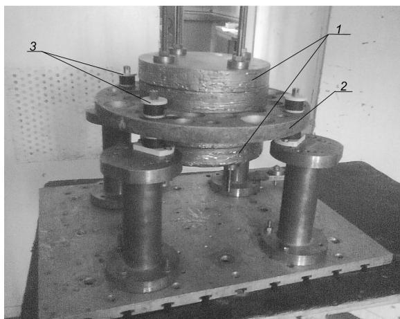
**Рис. 2.** Установка для испытаний: 1) эквивалент нагрузки; 2) монтажная плита; 3) амортизаторы
