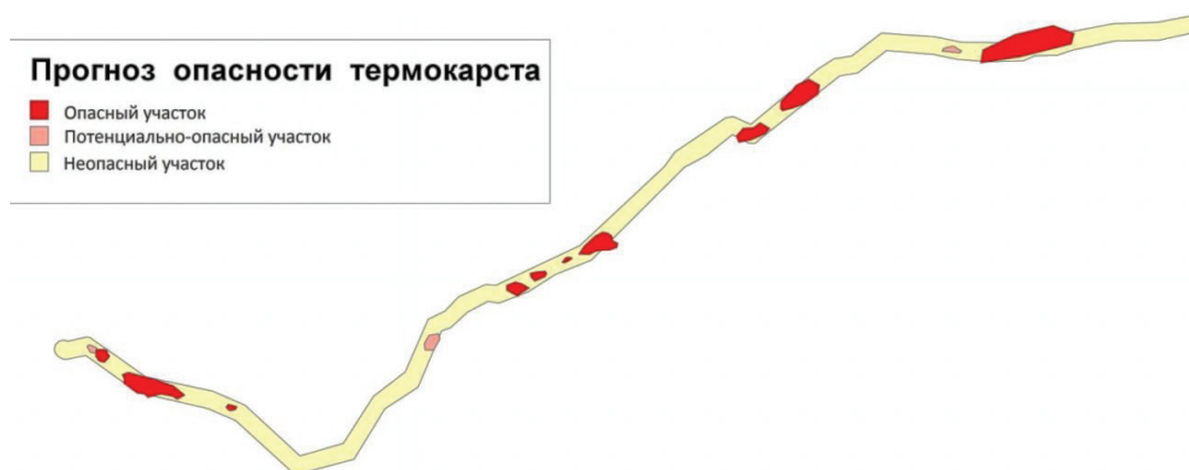
Рис. 8. Схема районирования по степени опасности термокарста
