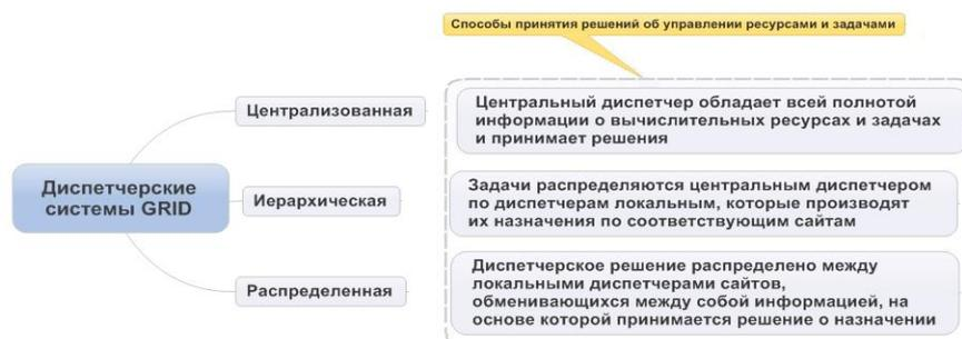
Рис. 1. Диспетчерская система управления задачами и ресурсами Grid
