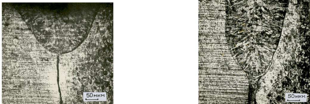
Рис. 3. Микроструктура зоны проплавления трещиноподобного дефекта при напряжении на модуляторе  $U_m=400$  В. Длительность импульса, мс: 1) 2,5; 2) 4,0
