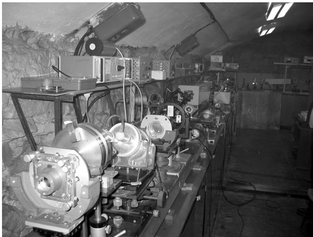
Рис. 3. Стенд для исследований воздействия импульсного лазерного излучения на вещество
