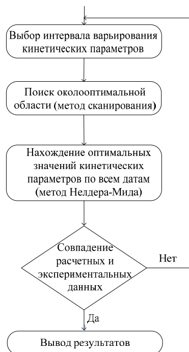
Рис. 8. Блок-схема алгоритма поиска кинетических параметров
