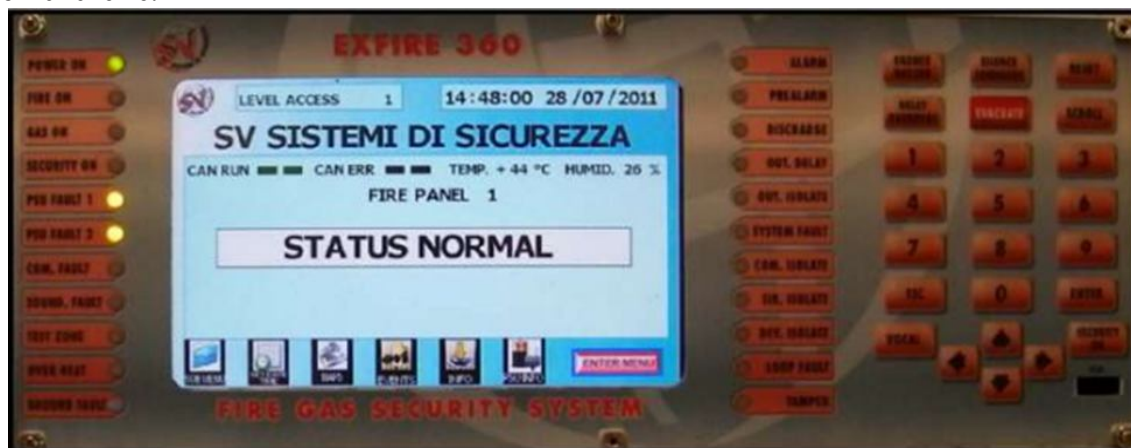
Рис. 2. Карта главного ЖК-дисплея (masterlcd)
