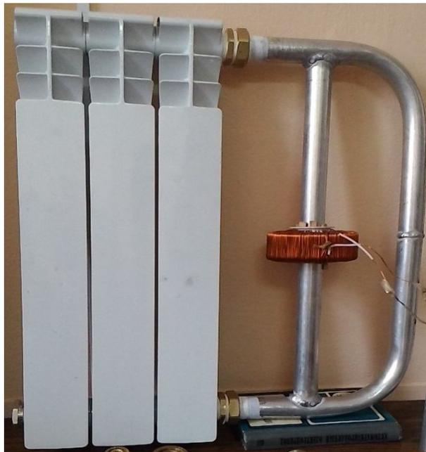
**Рис. 3.** Сборка трансформаторного нагревателя со стандартным радиатором
