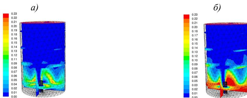
**Рис. 2.** Распределение скорости химической реакции,  $\text{кмоль}/(\text{м}^3 \cdot \text{с})$ , (а) и массовой доли кислорода,  $\text{кг}/\text{кг}$ , (б) в продольном сечении камеры сгорания
