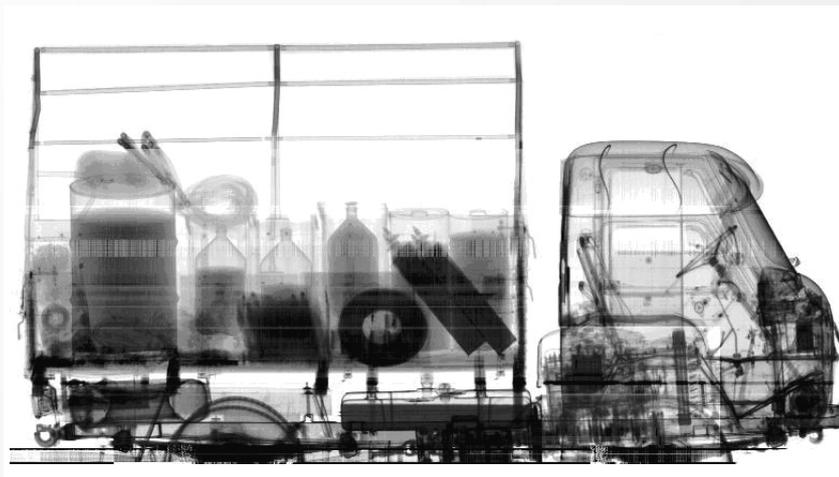
**Результат просвечивания бортового грузового автомобиля**
