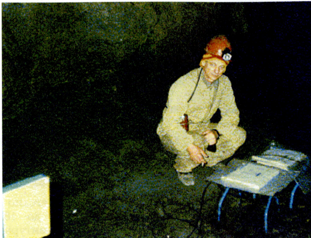
Испытания полевого автономного регистратора электромагнитных и акустических сигналов для диагностики геодинамических событий в шахте.
