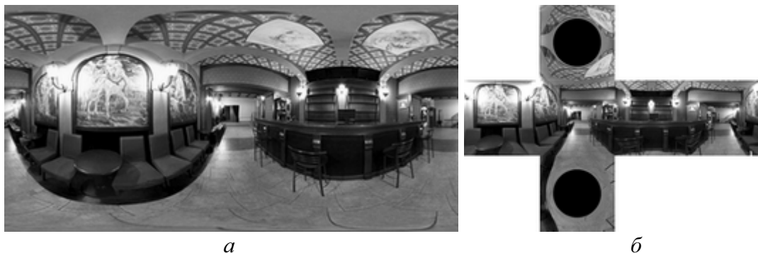
Рис. 1. Представление панорамы в виде проекций: а) эквидистантная; б) кубическая
