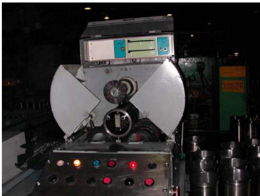
Рис. 1 Процесс дефектовки гильзы блока цилиндров дефектоскопом НТ-8
