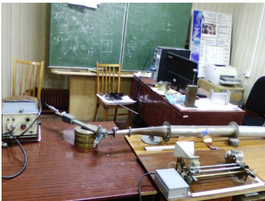
Рис. 2. Лабораторный макет радиоволнового дефектоскопа
