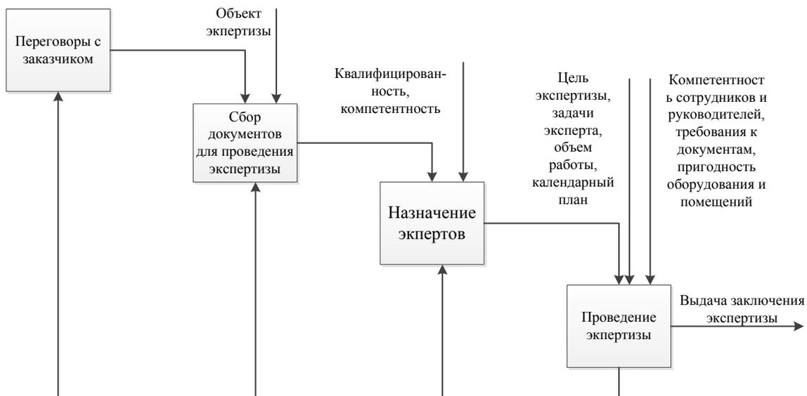
Рис. 5. Диаграмма декомпозиции процесса «Проведение экспертизы промышленной безопасности»
