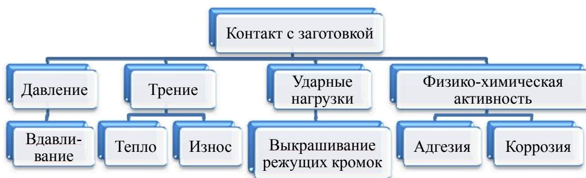
Рис. 1. Вредные факторы, возникающие при контакте инструмента с заготовкой
