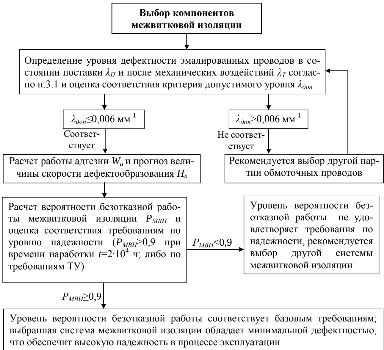
Рисунок 11 – Блок-схема проведения мероприятий по обеспечению минимального уровня дефектности \lambda межвитковой изоляции.
