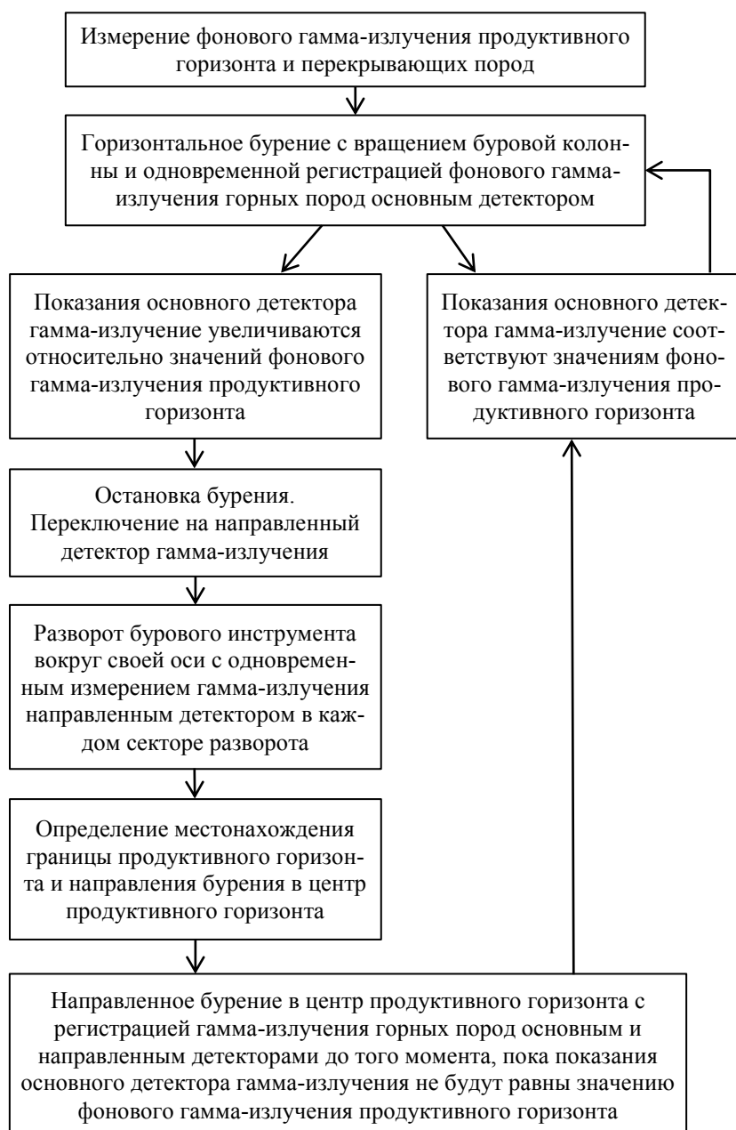
Рисунок 7 – Блок-схема процедуры контроля положения бурового инструмента в горизонтальной скважине
