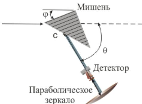
Рисунок 5 – Схема измерения углового распределения излучения, проходящего через мишень LHM-3
