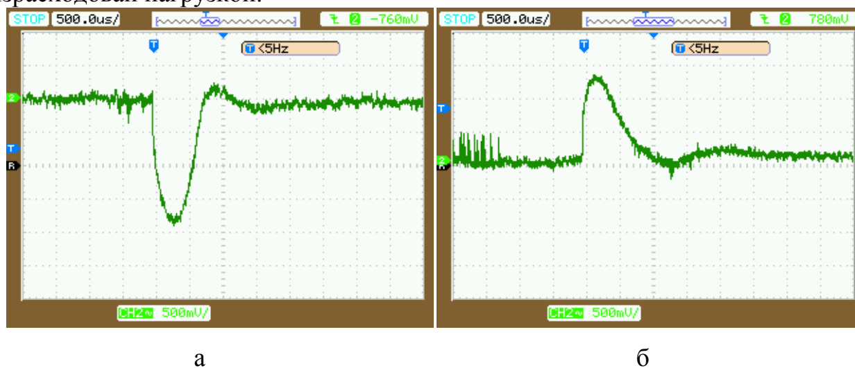
Рис. 16. Выходное напряжение ПН при резком: а – увеличении (набросе) нагрузки с 2 до 10 А ( U_{\text{вх}} = 32 В); б – при резком уменьшении (сбросе) нагрузки с 10 до 2 А ( U_{\text{вх}} = 32 В)
