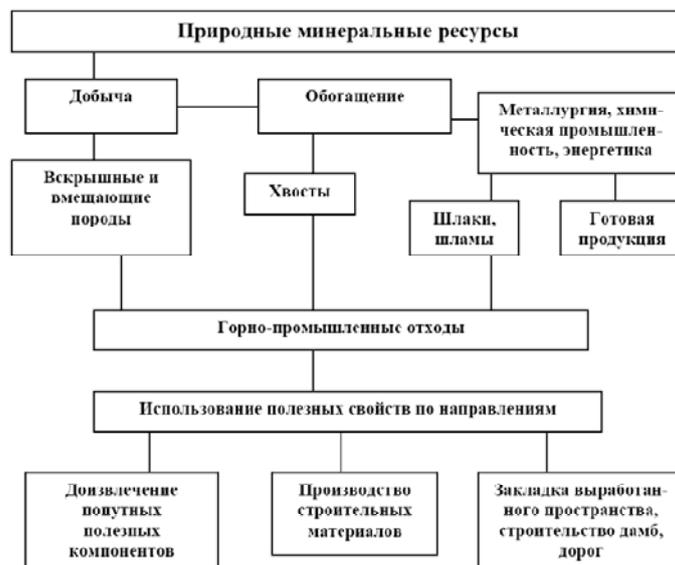
Рис. 1. Схема формирования и использования горно-металлургических отходов
