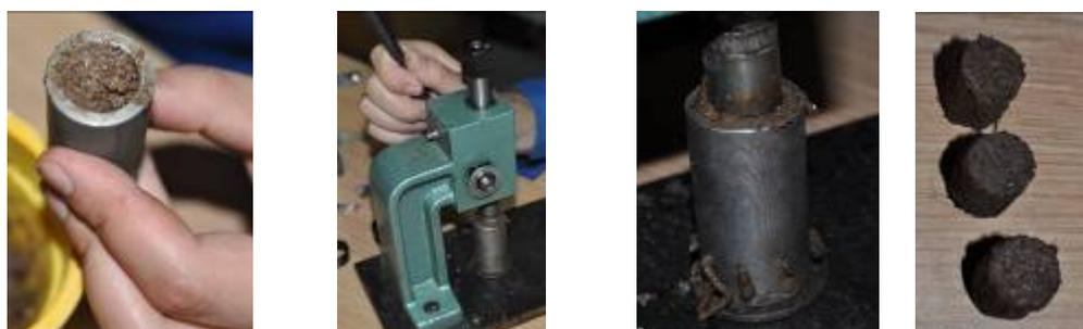
Рис. 2. Лабораторный брикетировочный пресс для производства гранул
