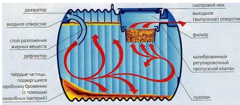
Рис. 4. Схема отстойника хозяйственно-бытовых сточных вод
