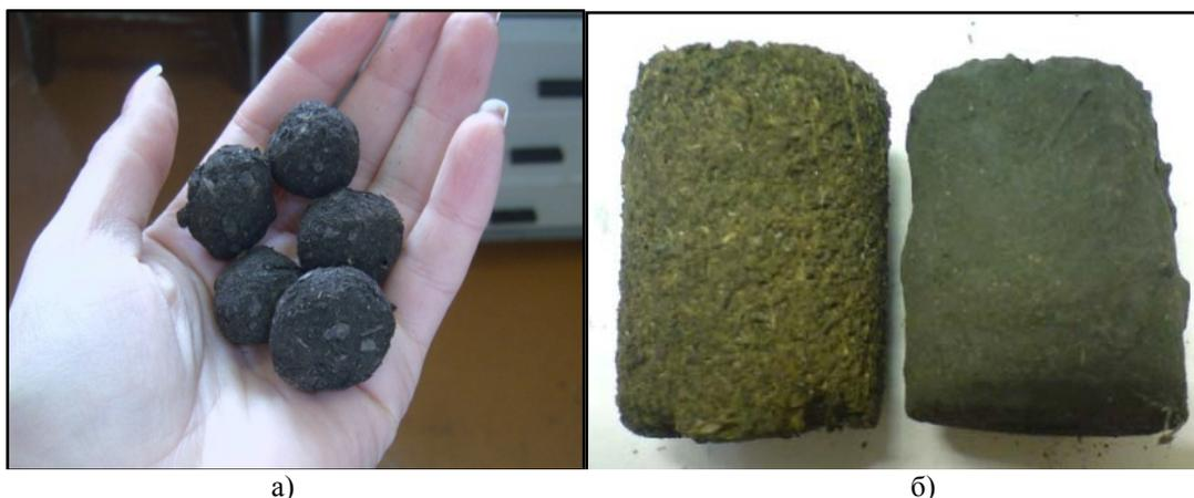
Рис. 2: Образцы топлива: а - повышенной прочности и теплоты сгорания;
