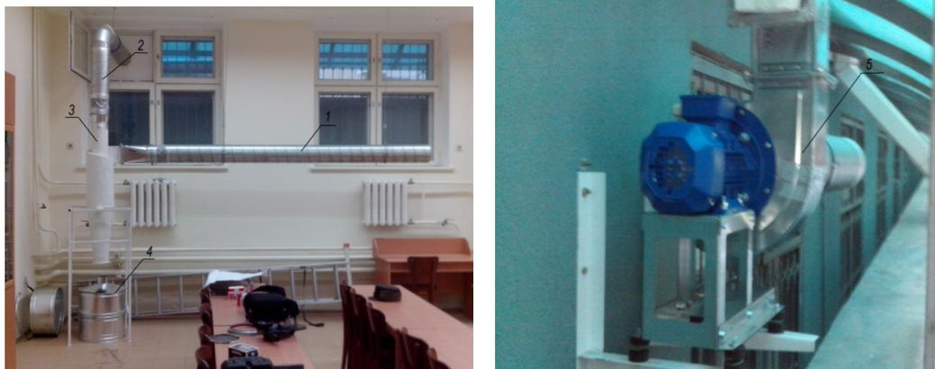
Рис. 1. Экспериментальная установка «Циклон»: 1 – входной патрубок, 2 – выходной патрубок, 3 – Циклон ЦН-15-300 (с помощью быстросъемных хомутов легко заменяется на ЦОК), 4 – бункер, 5 – радиальный вентилятор.
