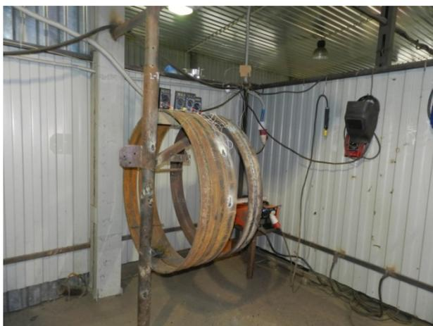
Рис. 1. Испытательный образец трубопровода, используемый в экспериментах
