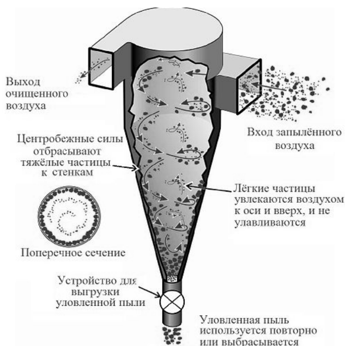
Рис. 2. Конструкция циклонного пылеуловителя промышленных предприятий
