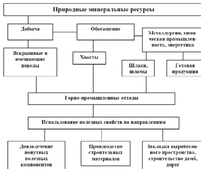
Рис. 1. Схема формирования и использования горно-металлургических отходов
