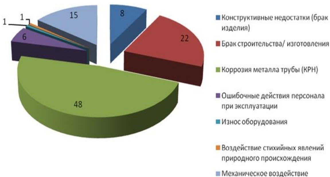
Рисунок 14 – Общее распределение причин аварий на магистральных газопроводах по данным Ростехнадзора за 2005–2015 гг. [33]
