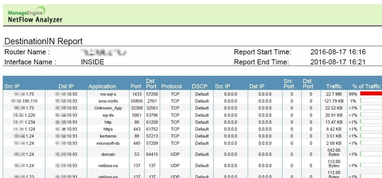
Рисунок А.2 – Измерение трафика при передаче данных с основного сервера DIRECTUM на АРМ делопроизводителя филиала
