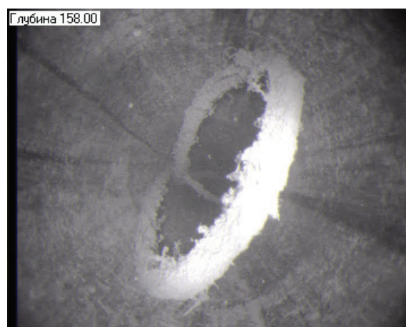
Рис. 2. Гибкий кабель в скважине
