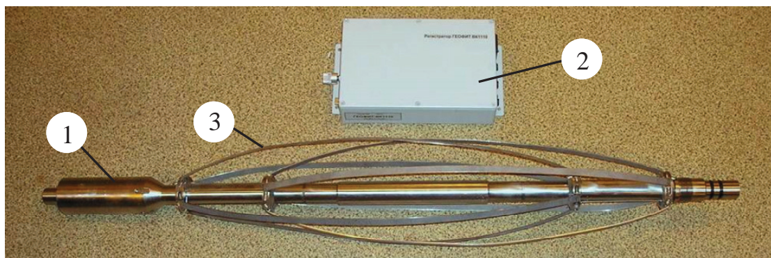
Рис. 1. Измерительный комплекс визуального контроля состояния скважин: 1 – скважинный прибор, 2 – наземный регистратор, 3 – плоские пружины
