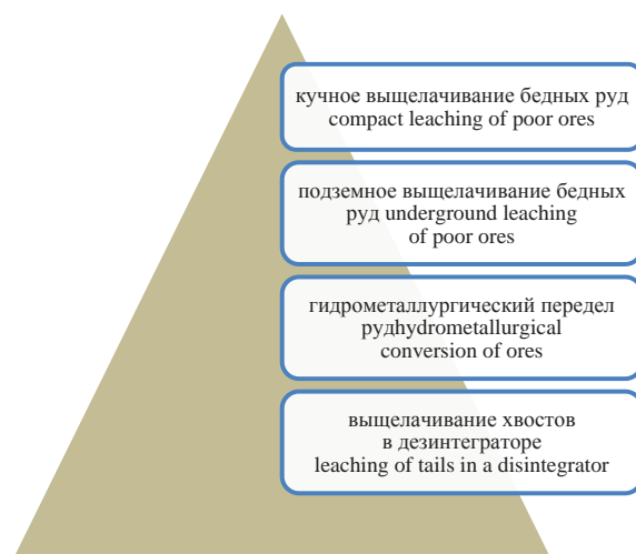
Рис. 2. Варианты технологий с выщелачиванием металлов из руд
