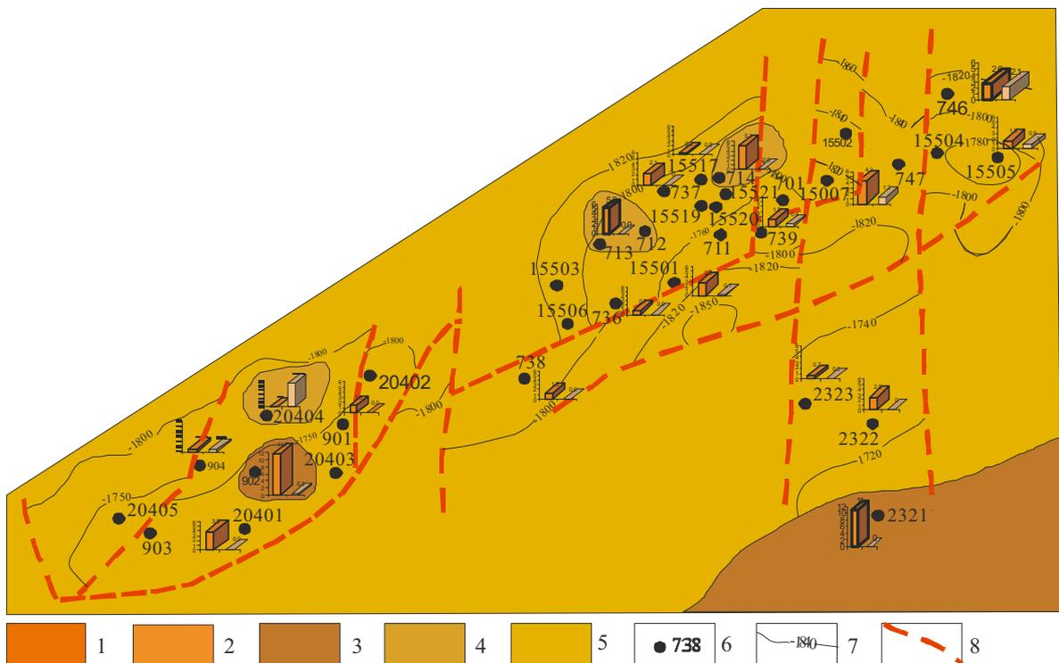
**Рис. 3.** Схема распределения глинистого цемента в породах улаханского горизонта. На гистограммах: 1) гидрослюдистый цемент; 2) битуминозно-гидрослюдистый цемент; зоны по содержанию глинистого цемента: 3) более 10 % с единичными прослоями до 40 %; 4) 5...10 % с единичными прослоями до 30 %; 5) 1...5 % с редкими прослоями до 10 %; 6) номера скважин; 7) изогипсы кровли улаханского горизонта; 8) разломы
