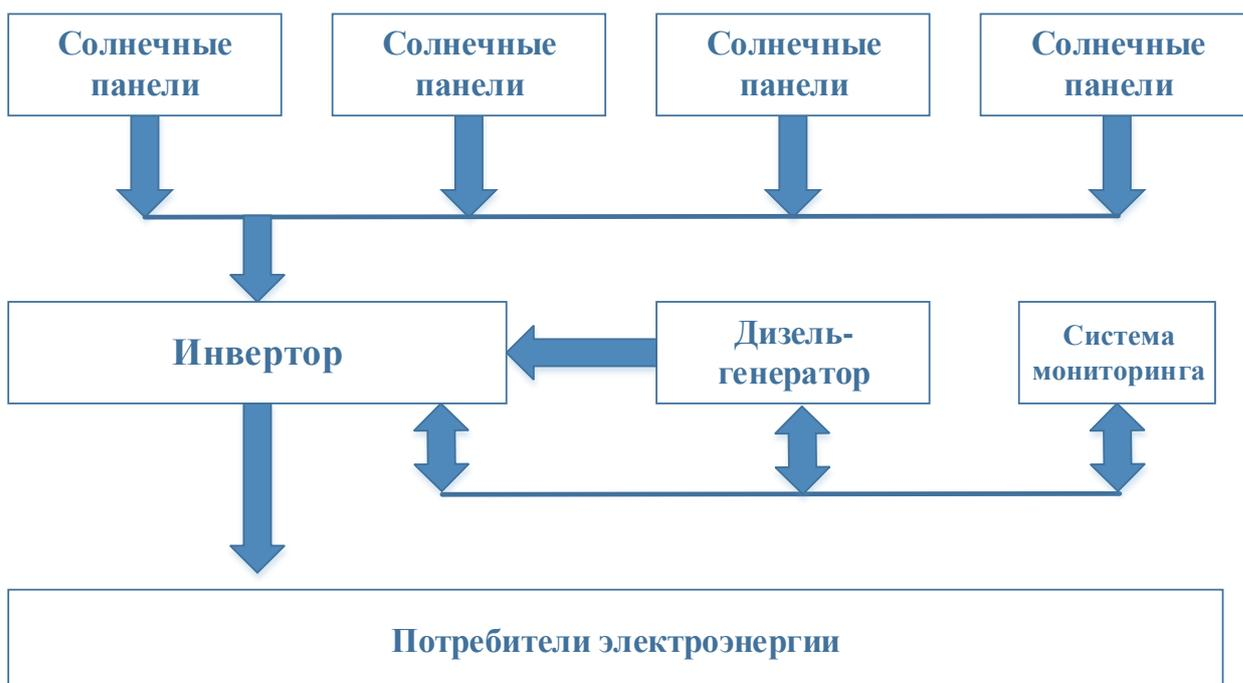
Рисунок 3.12 – функциональная схема фотоэлектростанции.
