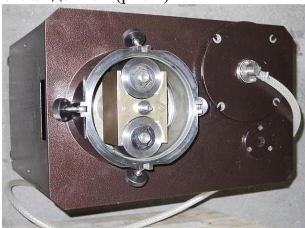
Рисунок 2 Общий вид активатора планетарного типа АГО-2С
