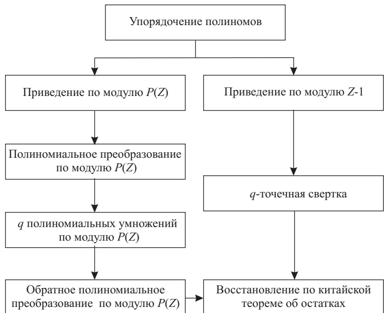
Рис. 1. Схема вычисления циклической свертки с помощью ПП [2]
