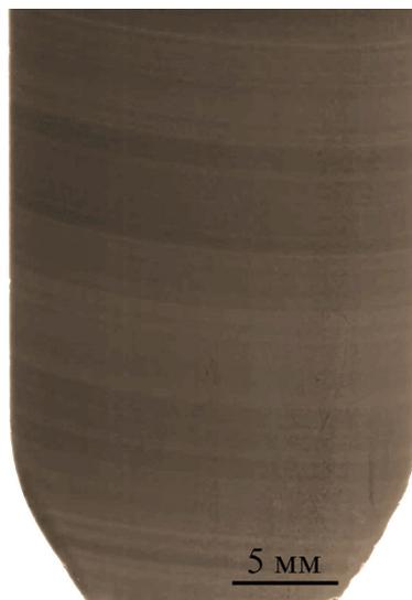
Рис. 1. Типичные полосы роста в  $ZnGeP_2$
